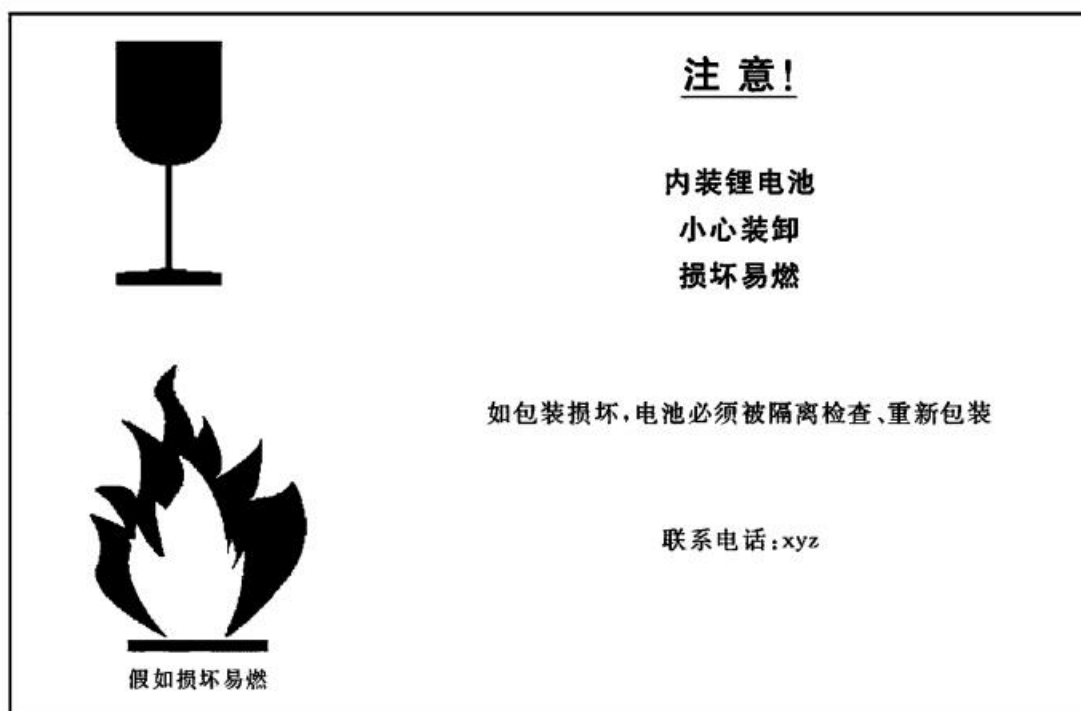
图1 储能系统舱包装标志示例
