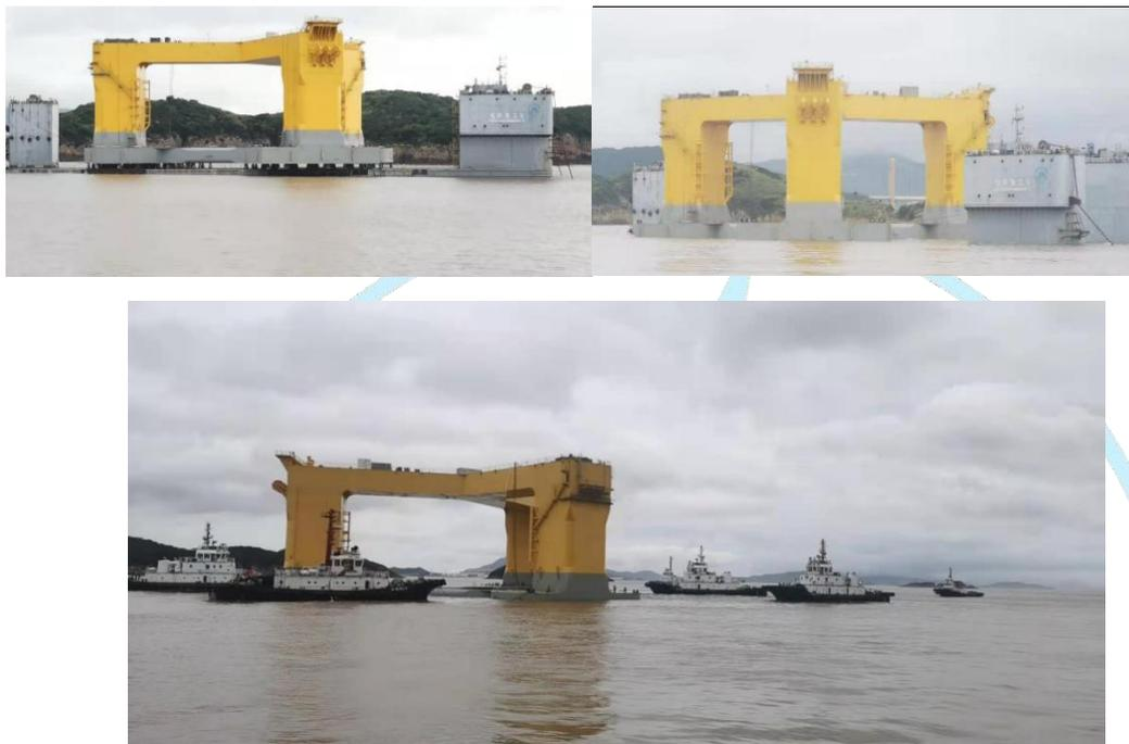
图7-4 半潜船运输浮式风电机组深海浮起转湿拖过程中
